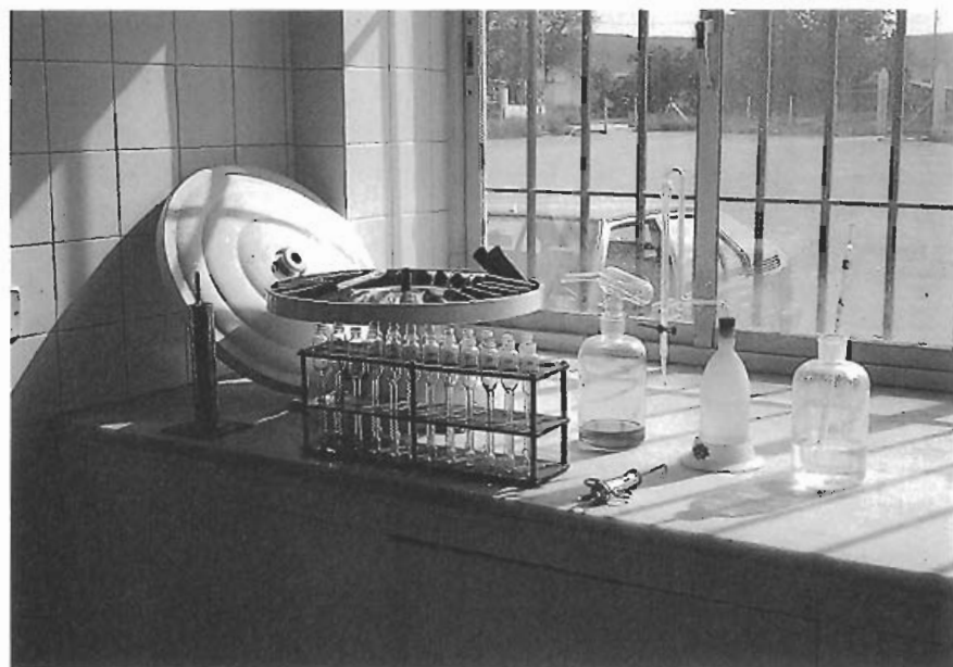
Gráfico N.º 15.-Laboratorio de quesería con material para determinación de la acidez total de la leche y su contenido graso.
