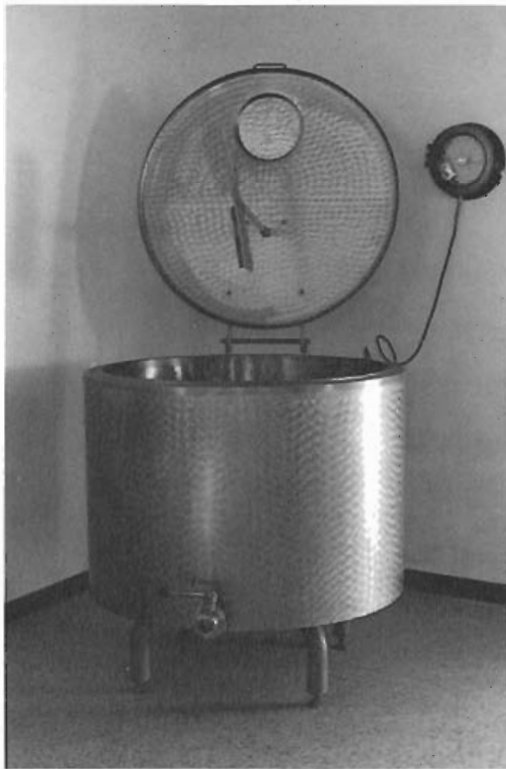
Gráfico N.º 9.- Cuba para la pasteurización lenta discontinua, provista de agitador y termógrafo. (Cortesía de Repuestos Xerez).
