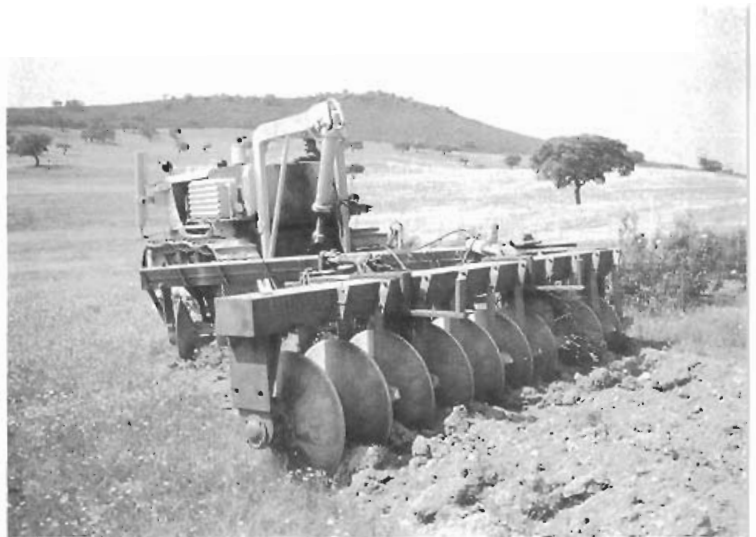
Gráfico 12. Potente grada idónea para el desbroce de terrenos con fuerte invasión de matorral.
