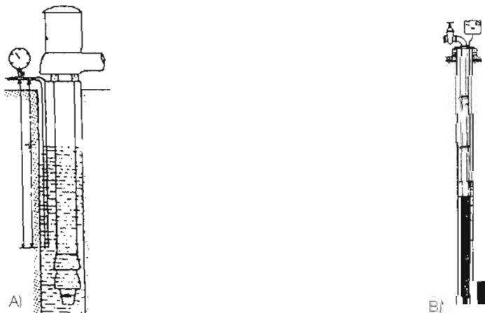
▲ Fig. 5: A) Bombas sumergidas. B) Bombas buzo
