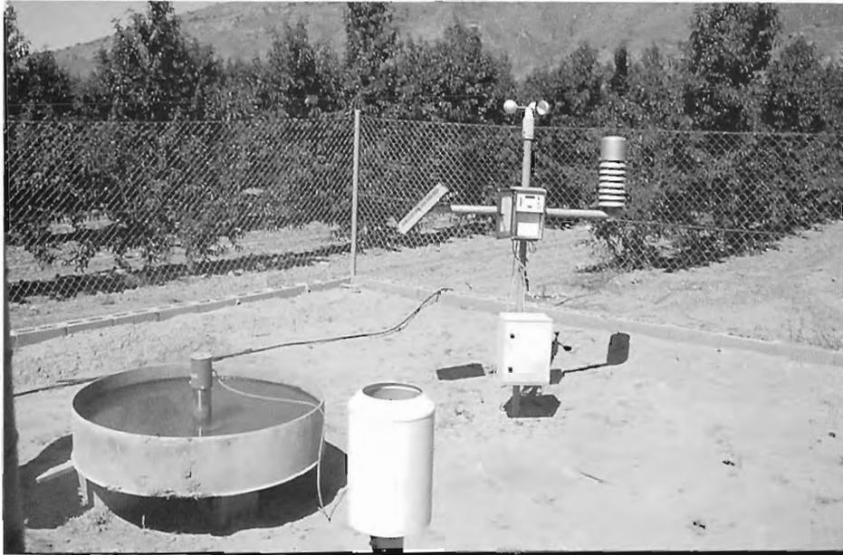
**Fotografía 3:** Para poder programar el riego es necesario disponer de datos climatológicos tales como pluviometría, temperaturas, humedad relativa del aire, radiación solar, velocidad del viento, etc. En la foto estación climatológica automática con toma y almacenamiento de datos por ordenador. Esta estación consta de diferentes instrumentos: termómetro, pluviómetro, radiómetro, anemómetro, y un tanque evaporimétrico clase A. El registro de los datos se realiza cada hora.
