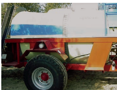
Figura 3. Depósito de poliéster
