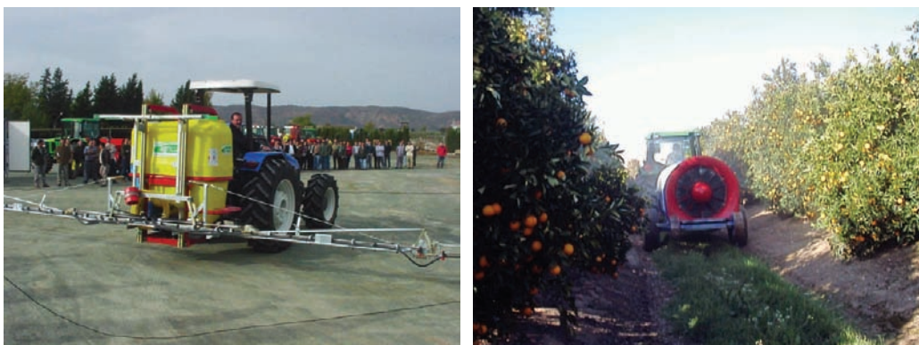
Figura 1. Pulverizadores, hidráulico a la izquierda e hidroneumático a la derecha
