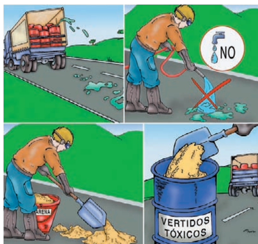
Figura 7. Los vertidos de derrames serán eliminados de forma controlada, utilizando el equipo de protección necesario
