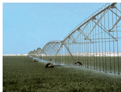
Figura 11. Sistema automatizado de riego por aspersión
