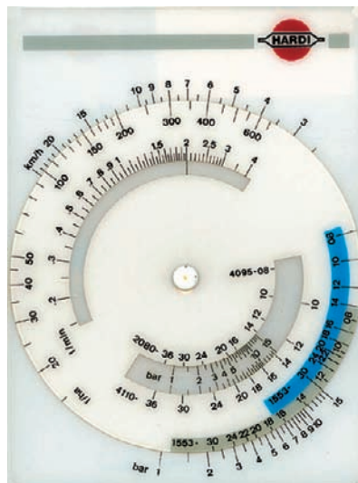
Figura 16. Modelos de tablas comerciales para la elección de boquillas
