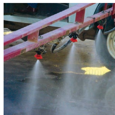
Figura 8. Para conseguir una buena uniformidad es necesario comprobar el caudal de las boquillas
