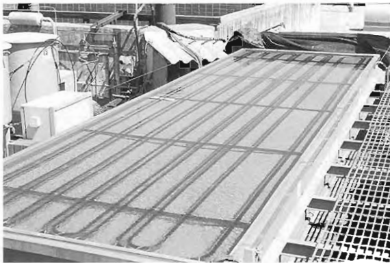
Fig. 38. Detalle del sistema de captación de luz del fotobiorreactor tubular.
