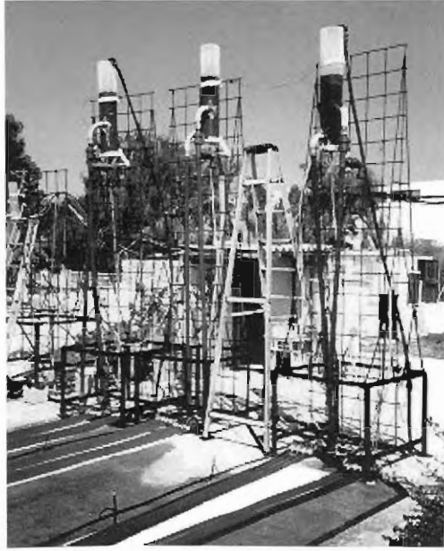
Fig. 9. Fotobiorreactor tubular para cultivo de Haematococcus en "The Jacob Blaustein Institute for Desert Research" Universidad Ben-Gurion, en Israel (cortesía del Prof. S. Boussiba).
