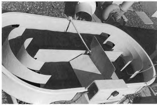
Fig. 25. Detalle del diseño de las paletas en los estanques experimentales de 3 \text{ m}^2 .
