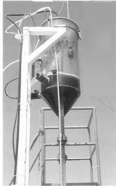
Fig. 39. Detalle del cilindro de desgasificación del fotobiorreactor tubular.
