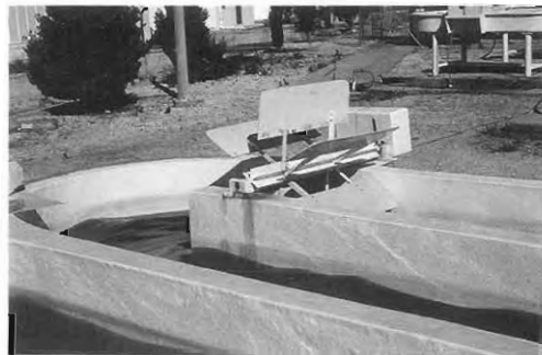
Fig. 26. Detalle del diseño de las paletas en los estanques de producción de 40 \text{ m}^2 .
