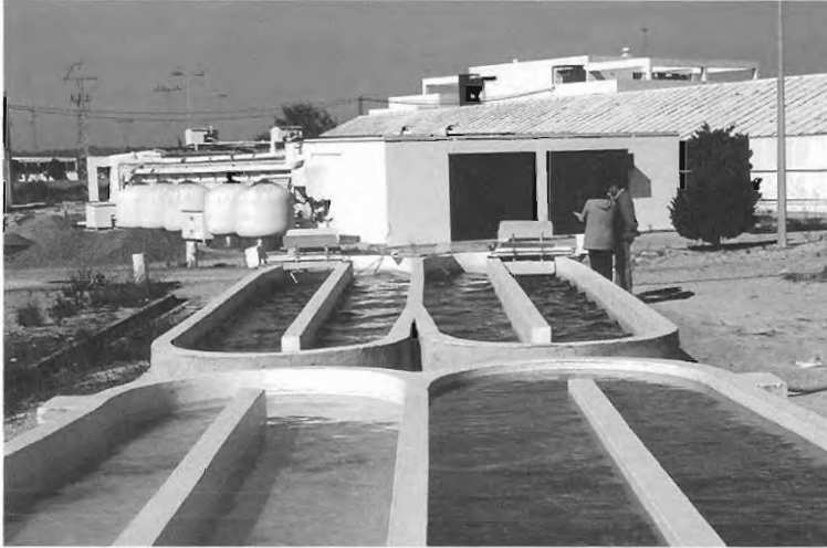
Fig. 7. Sistema abierto de tipo intensivo para el cultivo de Dunaliella .
