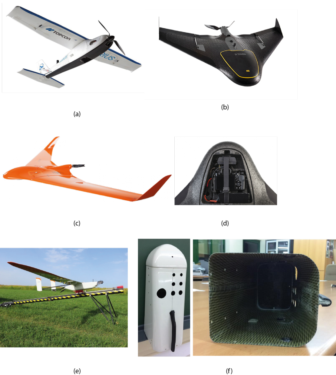
Figura 26 Plataformas ala fija: (a) Mavinci Sirius Pro, (b) UX5, (c) Bramor rTK, (d) detalle instalación sensor (e) E300 y (f) detalle morro E300
