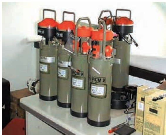
Fotografía 3-22 Correntímetros AANDERAA RCM-9 y DCM-12 con sus unidades de almacenamiento (DSU).
