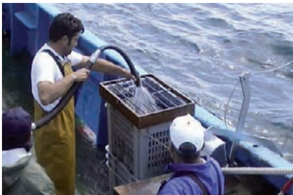
Fotografía 3-9 Batería de tamices utilizada en los muestreos.
