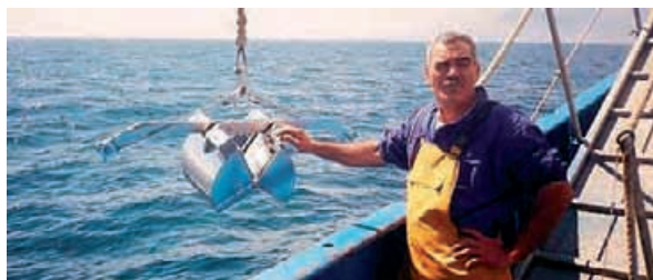
Fotografía 3-8 Dragas Van Veen utilizadas para el muestreo de fauna bentónica.
