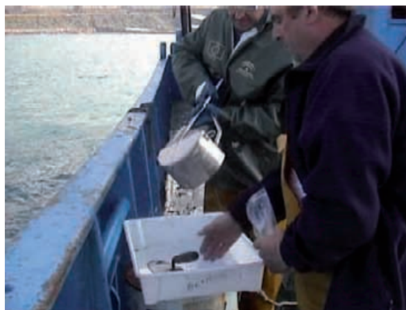
Fotografía 3-6 Muestreo de sedimentos con draga Van Veen.
