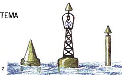
Marcas de estribor
