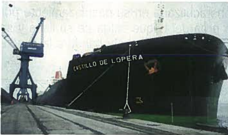
Los norays suelen estar dispuestos en las orillas de los muelles
