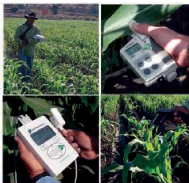
Figura 11.4. Diferentes equipos portátiles que permiten evaluar de manera relativamente rápida, sencilla y económica el crecimiento, fenología y estado hídrico de la planta: espectroradiómetro con sensor activo que mide NDVI (arriba izquierda), medidor foliar de contenido en clorofila (arriba derecha), porómetro, para medir conductancia estomática de la hoja (abajo izquierda) y “pistola” de infrarrojos (abajo-derecha) para medir la temperatura de la cubierta vegetal.
