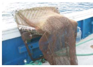
Draga Van Veen y rastros con doble malla empleados para la toma de muestra de sedimento y la captura de fauna bentónica respectivamente
