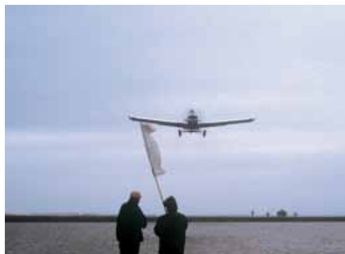
Figura 4. En tratamientos aéreos la avioneta nunca debe pasar por encima del ayudante
