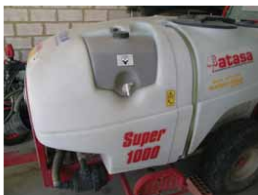
Figura 6. El depósito debe ser inspeccionado para evitar vertidos accidentales
