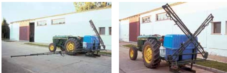
Figura 12. La barra portaboquillas debe plegarse para facilitar su transporte
