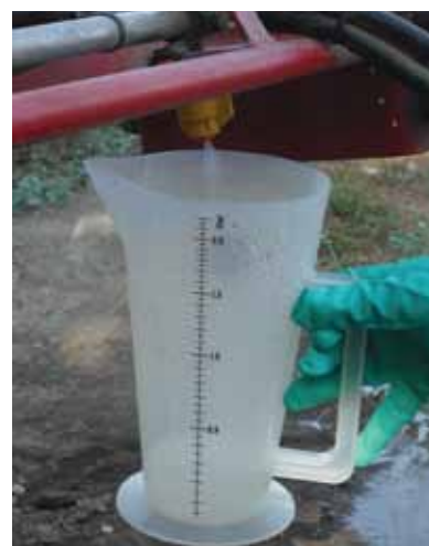
Figura 7. Medida del caudal de una boquilla
