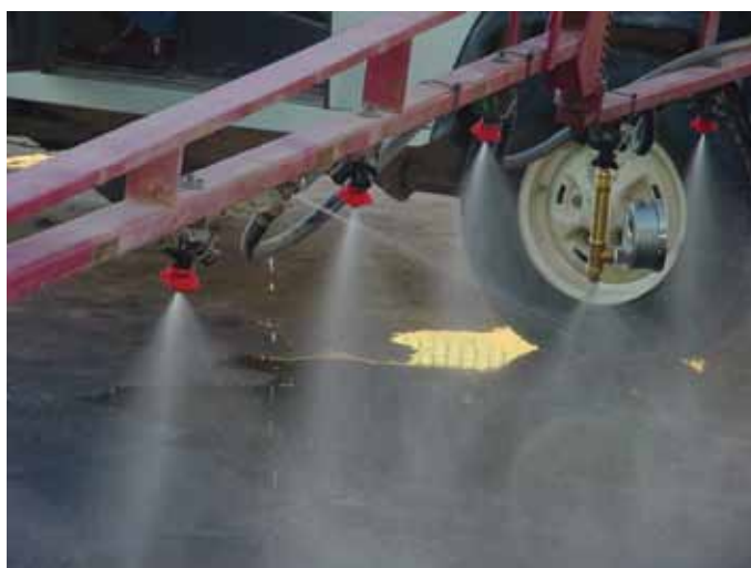
Figura 3. Tubería con fugas. Debe repararse antes de almacenar la maquinaria
