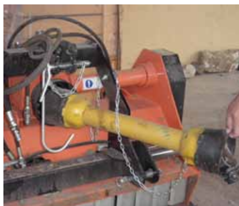
Figura 4. Toma de fuerza completamente protegida
