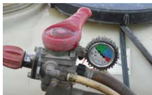
Figura 6. La presión de trabajo de la maquinaria debe ajustarse en función del tipo de boquilla
