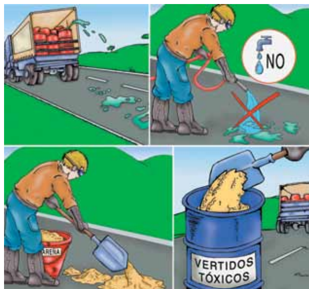
Figura 5. Los vertidos de derrames serán eliminados de forma controlada, utilizando el equipo de protección necesario
