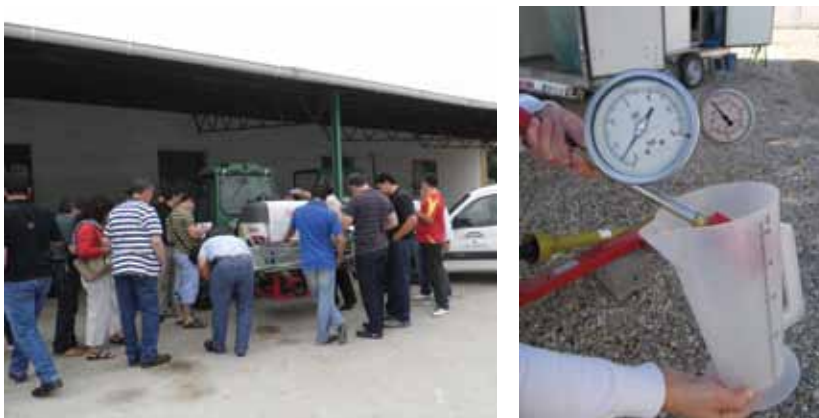
Figura 1. Prácticas de revisión y calibración de equipos de aplicación de fitosanitarios
