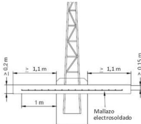
**Figura 4.- Solera CTI con mallazo electrosoldado.**
