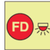
Espacio protegido por alarma automática de incendios
