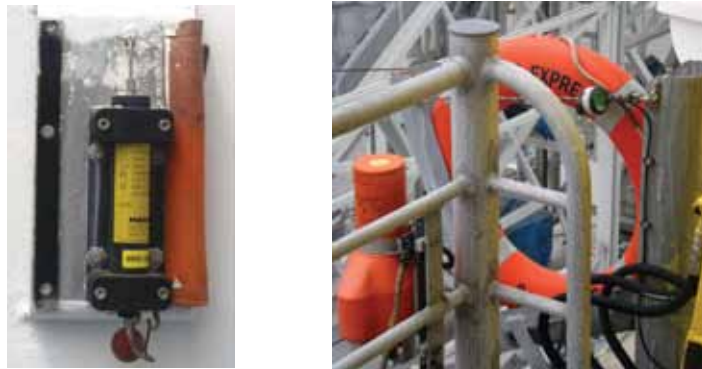
Figura 28. Bomba de activación y aro salvavidas con mecanismo automático de suelta rápida
