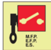
Control remoto de bomba de incendio o interruptores de emergencia
