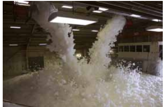
Figura 54. Compartimentos inundados con espuma de alta expansión
