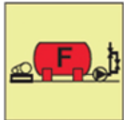
Instalación de espuma
