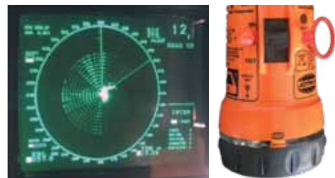
Figura 48. Modo TEST y activación del SART
