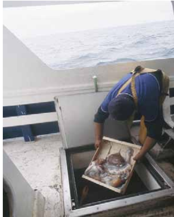
Riesgo de caída a distinto nivel
