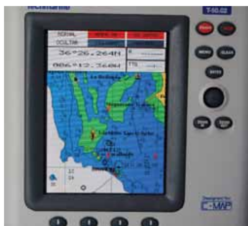
Figura 36. Pantalla de navegación con plotter con cartografía digital
