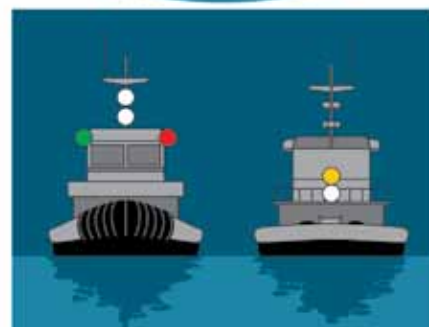
Figura 15. Buque remolcando remolque menor de 200 metros
