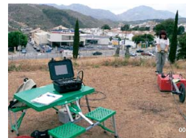
001. Exploración con radar 3D en la cúpula del Dolmen de Viera. En primer término aparece la consola de gestión de los datos y en segundo la antena de 200 MHz / Imagen: José Antonio Peña Ruano, Teresa Teixidó Ulloa
