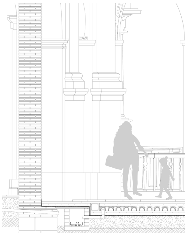
Adecuación. Sección general del encuentro del pavimento con los alzados. Fuente: Fondo gráfico IAPH. Imagen del estado final. Fuente: Fondo gráfico IAPH (Aurora Villalobos Gómez)
