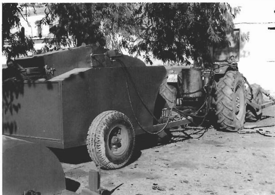
Fotos n os 27 y 28 Recogedora-limpiadora-cargadora.
