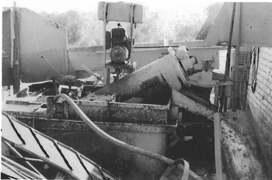
Foto nº 40. Lavadora de aceituna funcionando por densidad.
