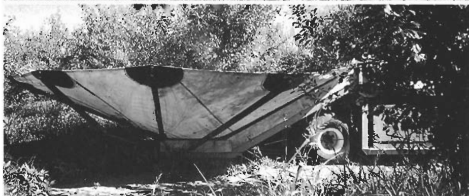
Fotos n.º 55, 56 y 57. Vibrador con triciclo autopropulsado y receptáculo recogedor de fruto O.M.C.
