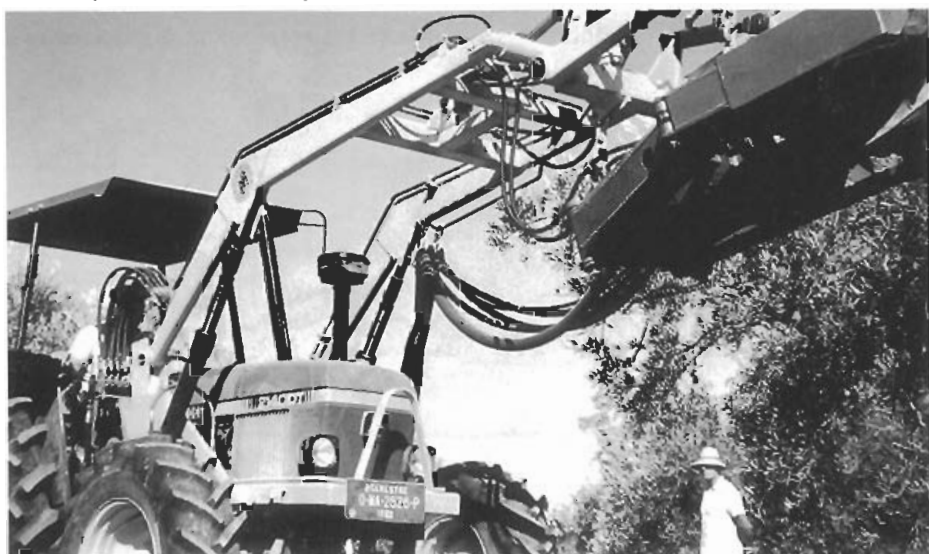
Foto n.º 14. Vibrador comercial SADRYN con acumulador de energía.
