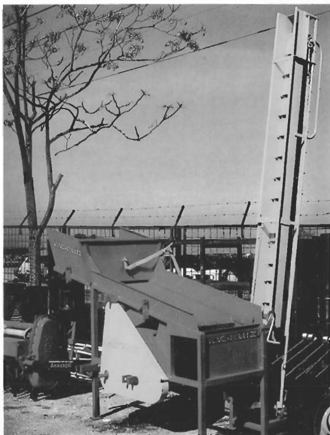
Foto n° 36. Limpiadora accionada por la toma de fuerza del tractor.
