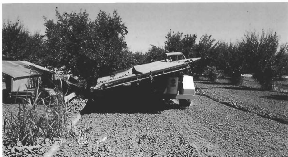
Fotos n.º 52 y 53. Equipo de recolección KILBY recogido para el movimiento y en el momento de efectuar la vibración (nótese el desplazamiento de los planos inclinados, receptores del fruto derribado).
