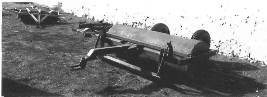
Foto n.º16. Rulo compactador con cuchilla niveladora.
