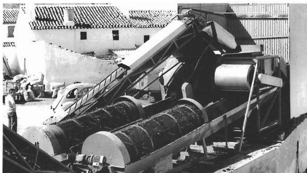
Foto n.º 41. Lavadora de aceituna funcionando por arrastre.
