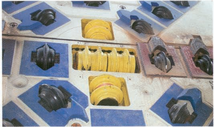
Foto 5. Detalle de un cortador de disco de la cabeza de corte. Photo 5. Detail of a disc cutter of the cutting head.
