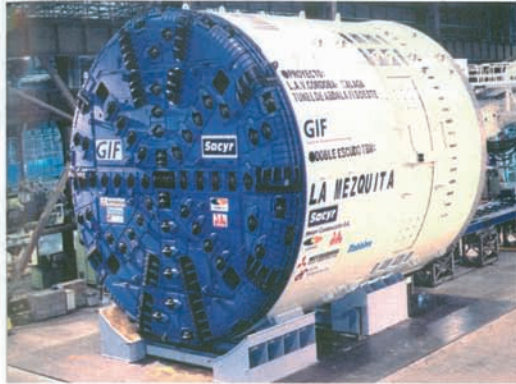
Foto 3: Tuneladora del túnel Oeste en la factoría. Photo 3. TBM for the West tunnel in the factory.
