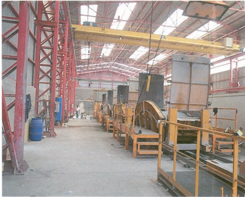
Foto 10. Molde de fabricación de una de las dovelas. Photo 10. Manufacturing moulds for one of the segments.
