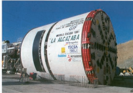
Foto 3 bis. Tuneladora del túnel Este una vez finalizado su montaje en obra/Photo 3bis. TBM for the East tunnel assembled on site.
