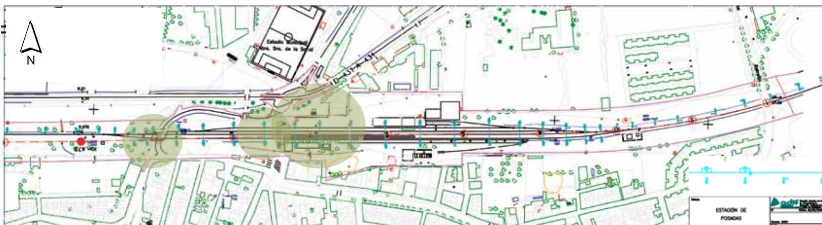
Tramo de la travesía urbana con el emplazamiento de la estación y los pasos transversales
