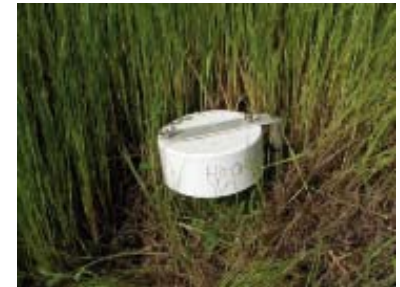
Arriba; Foto 6. Hobo H8 instalado en un terraplén.
