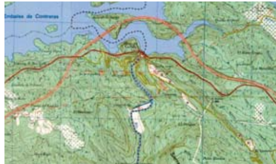
Arriba izquierda; Figura 10. Trazado del Camino de Valencia a su paso por el río Cabriel. Las 32 leguas de camino entre Saelices y Requena, en las que destacan las obras del Puerto de Contreras, fueron proyectadas y construidas por Lucio del Valle entre 1846 y 1855. Hojas 692 y 693 de la serie 1:50.000 del IGN. 1948 y 1947.
