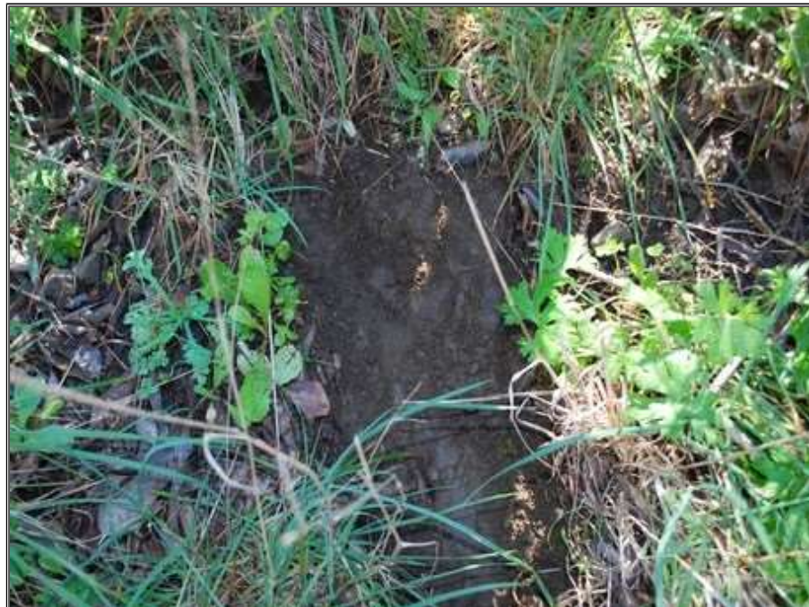
Cata de la coronación del cerro donde se ubica el estribo izquierdo. Se aprecia una primera capa de tierra vegetal.
