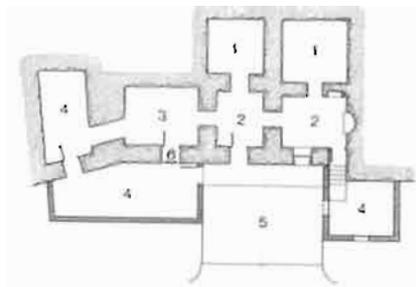
Casa Cueva. Los Garfios. Baza. Granada. Ejemplo de excavación en fosa cuyo acceso se soluciona mediante una rampa.
