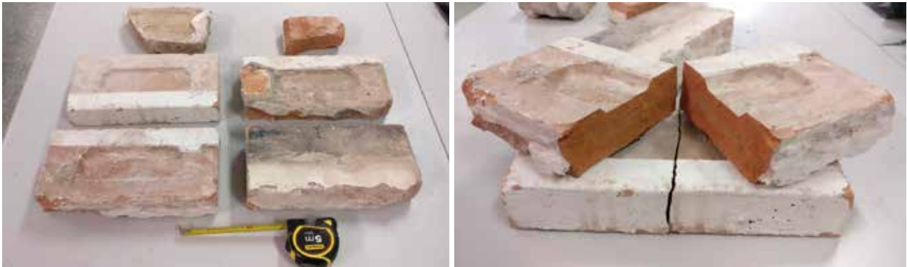
A la izquierda: Conjunto de ladrillos y piezas cerámicas originales, 2018. A la derecha: Aspecto interior del ladrillo después de ser sometido a los ensayos mecánicos, 2018
