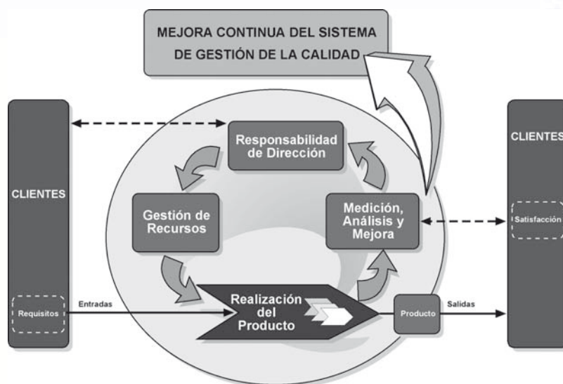
Modelo de un sistema de gestión de la calidad basado en procesos (según ISO 9001:2000)
