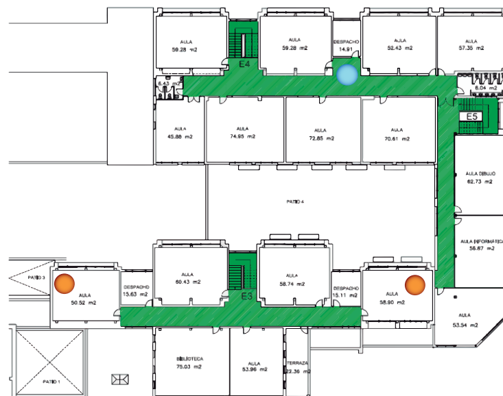
Diseño de planta con zonas que presentan una sola opción de salida de planta y zonas con alternativa.
