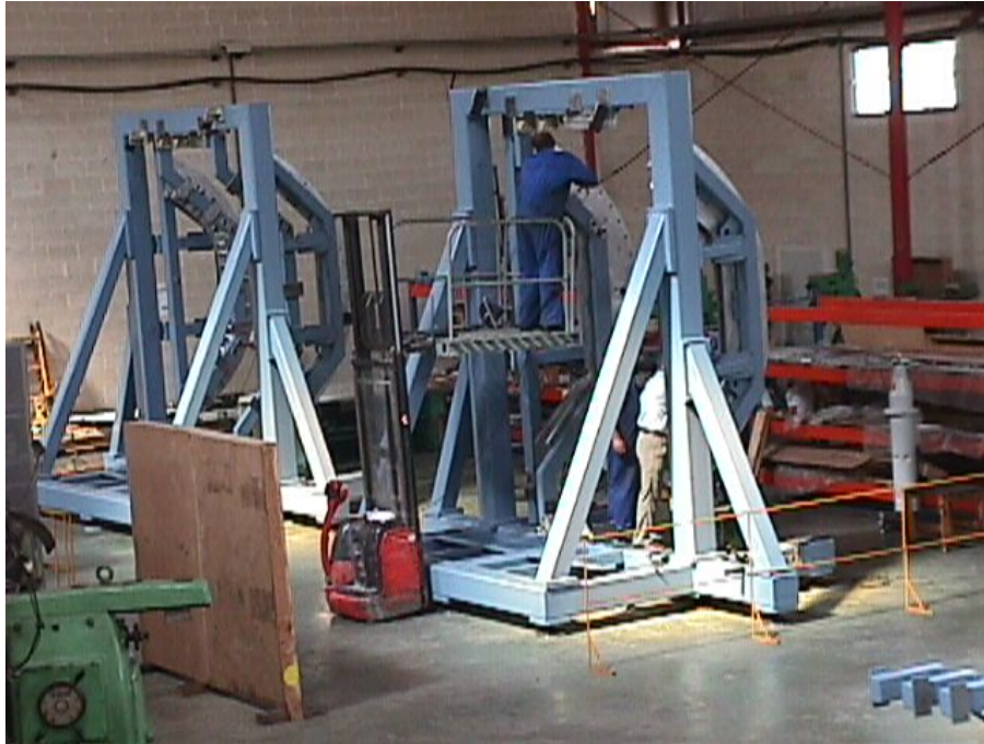
Talleres González Jaramillo. Construcción de grada de montaje del Fuselaje del DO-728 JET
