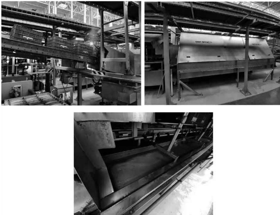
Figura 8: Detalle de una línea de lavado de cajones de campo con agua caliente (50°C) a presión, instalada en una central citrícola de Museros (Valencia). Se observan muchos restos procedentes del lavado.
