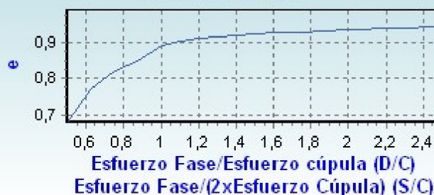
Esfuerzo horizontal que soportan los apoyos con cúpula GCO h=7,65 b=5,6
