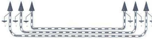
Ilustración 22. Puesta a tierra de cubiertas metálicas
