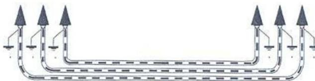
*Ilustración 20. Puesta a tierra de cubiertas metálicas*
