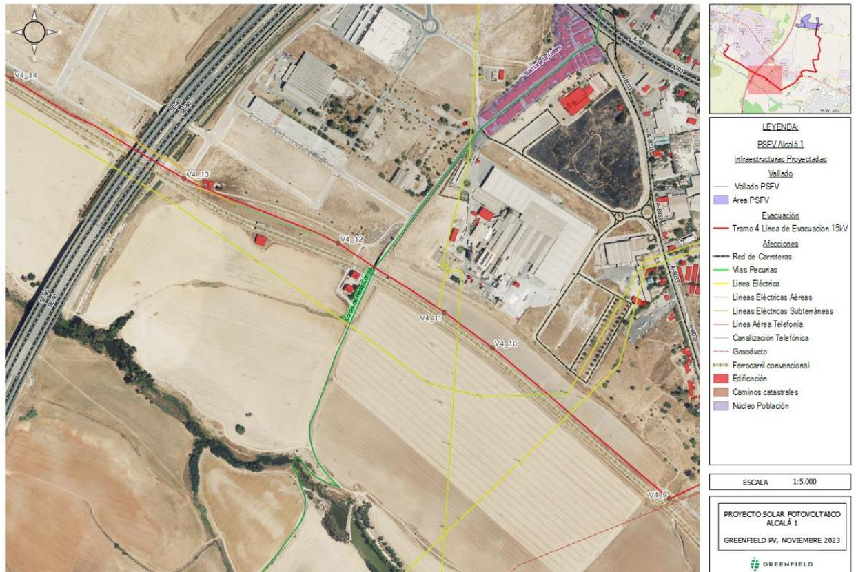
Imagen 12: Línea de evacuación subterránea 15 kV Alcalá 1 Tramo 4.
