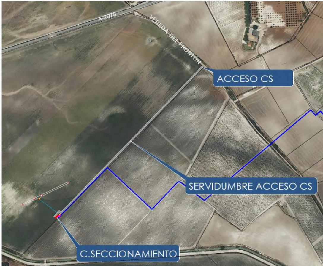
**Ilustración 20: Acceso al Centro de Seccionamiento.**
