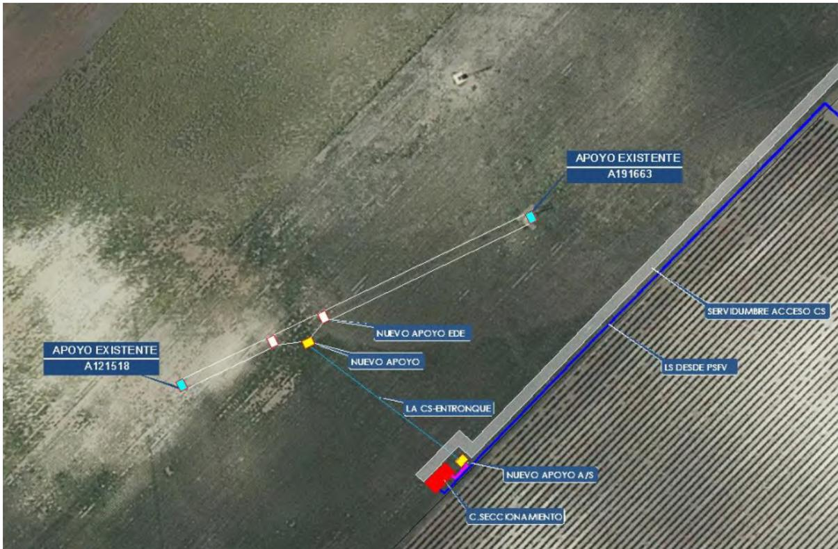
**Ilustración 17: Conexión con la Red de Distribución.**
