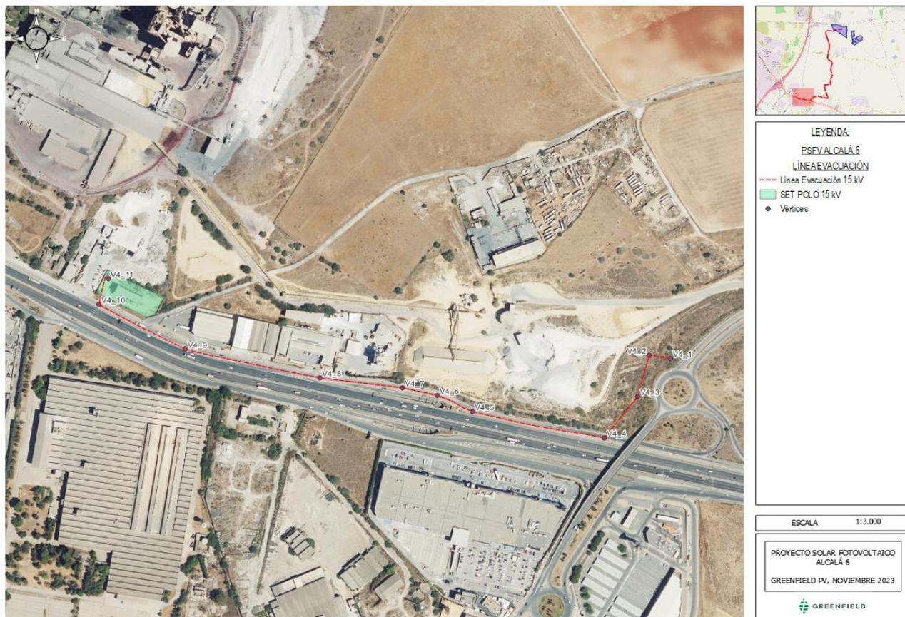
Imagen 13: Línea de evacuación subterránea 15 kV Alcalá 6 Tramo 4.
