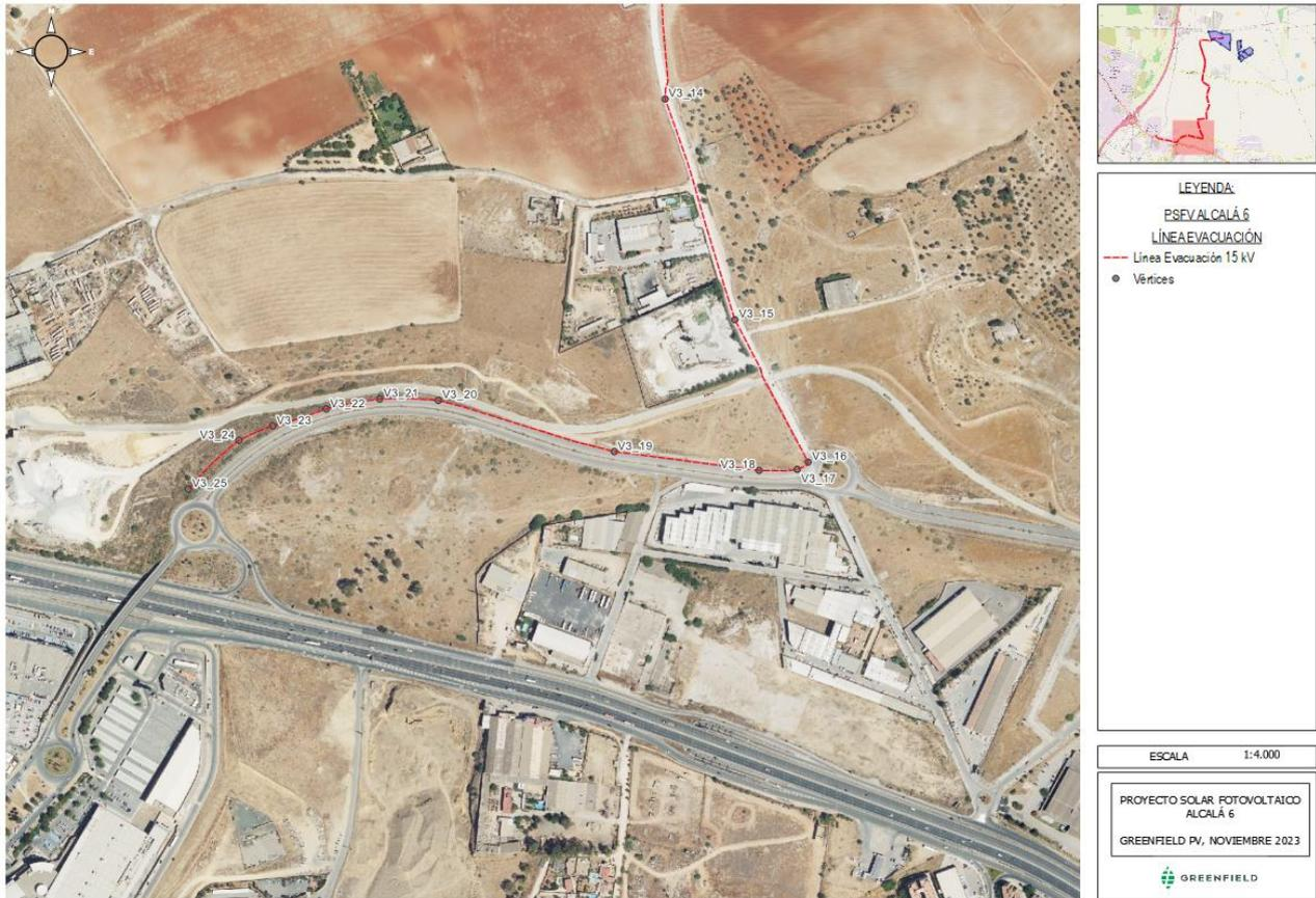
Imagen 12: Línea de evacuación subterránea 15 kV Alcalá 6 Tramo 3 (III).
