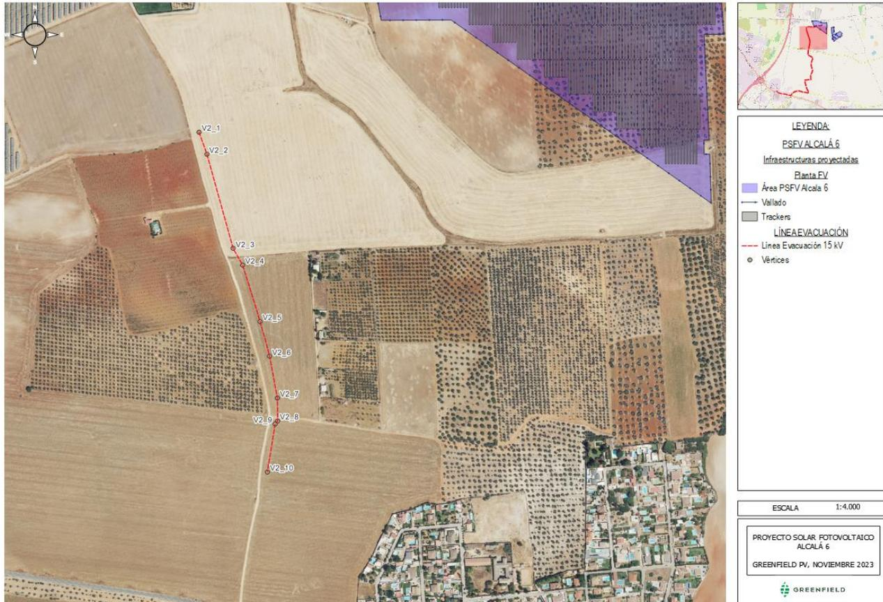
Imagen 9: Línea de evacuación subterránea 15 kV Alcalá 6 Tramo 2.
