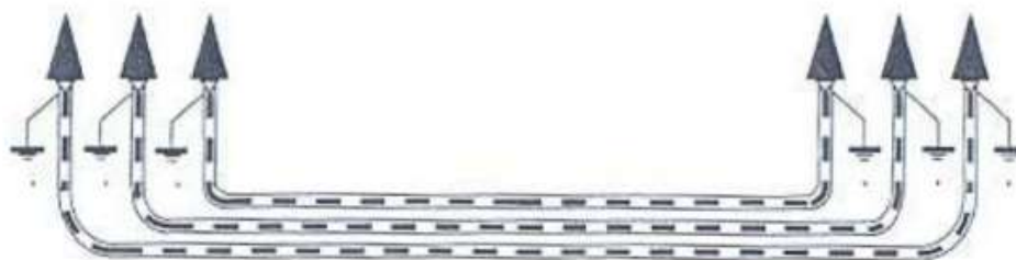
Ilustración 14. Puesta a tierra cubiertas metálicas
