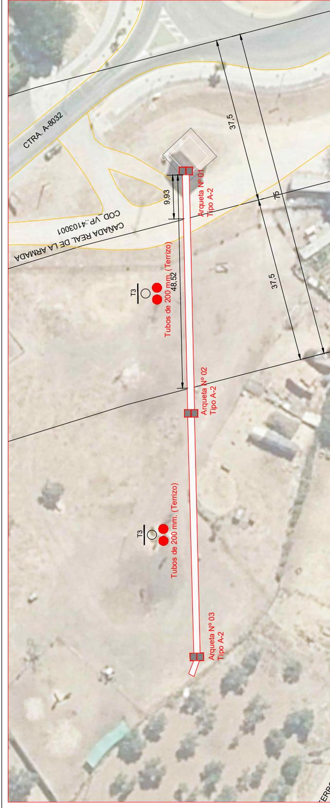
Se produce afección con esta vía por la instalación de un canalización nueva a realizar. Se considera que la vía tiene una anchura general de 75 m.
