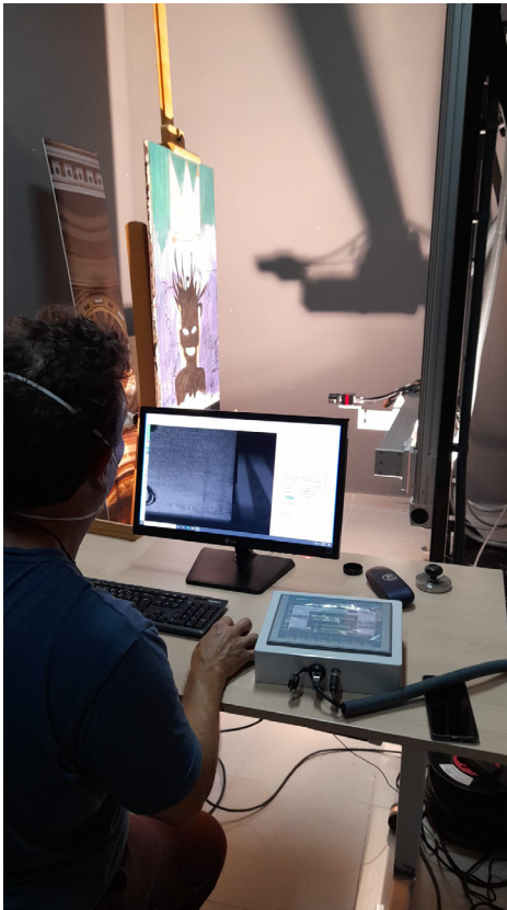
Identificación de pigmentos mediante fluorescencia de RX, en registro de un área de 10 x 10 cm, mediante brazo robotizado, en una pintura intervenida por el Grupo de Patrimonio del Cuerpo Nacional de Policía adscrito a la Generalitat Valenciana
