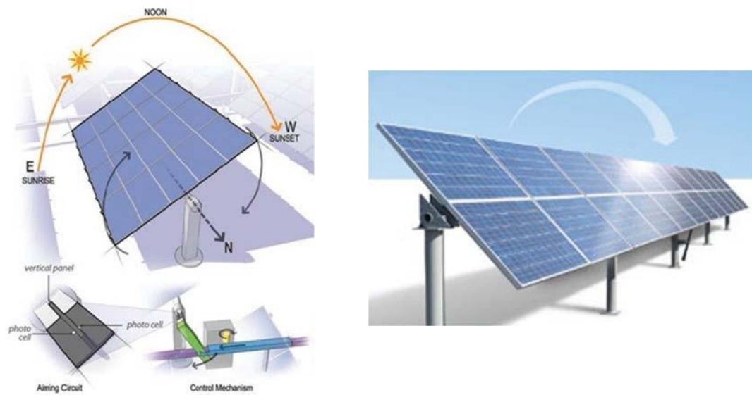
Fig. 1.1. Detalle de los seguidores fotovoltaicos de ambos proyectos. Fuente: proyecto técnico.
