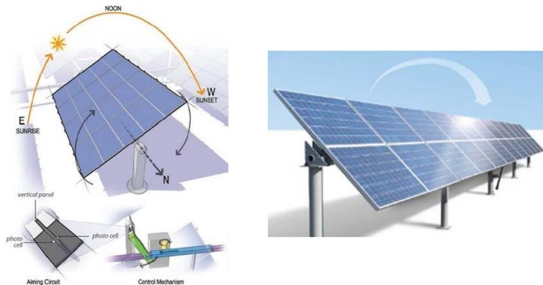
Fig. 2.1. Detalle de los seguidores fotovoltaicos de ambos proyectos. Fuente: proyecto técnico.
