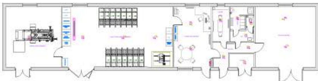
Ilustración 3. Distribución de detectores en edificio de control
