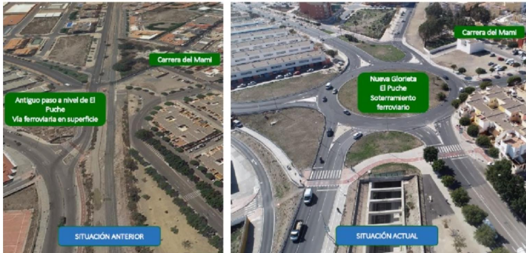
Imagen 148. Situación anterior y actual de la integración ferroviaria en el Puche. Fuente: ADIF.
