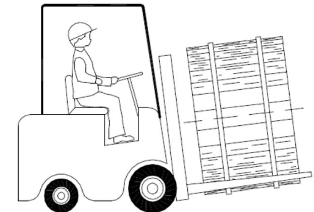
Carga y descarga del camión o plataforma de transporte. La carga y descarga de la bobina al camión o plataforma, debe hacerse mediante grúa o carretilla elevadora.
