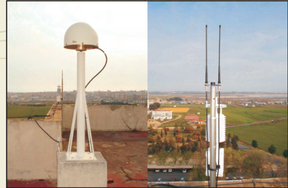
ANTENA GPS, ESTACIÓN METEOROLÓGICA Y ANTENA DE TRANSMISIÓN DE CORRECCIONES RTK EN HUELVA
