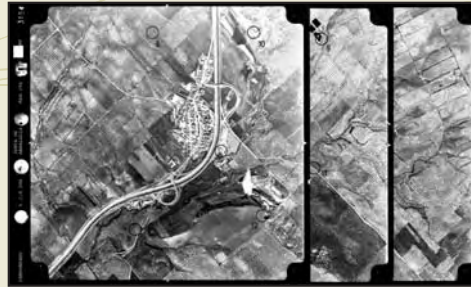
VUELO FOTOGAMÉTRICO FORMADO POR UNA PASADA CON TRES FOTOGRAMAS
