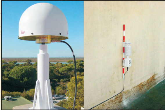
ANTENA GPS Y ESTACIÓN METEOROLÓGICA DE LA RAP EN CÁDIZ
