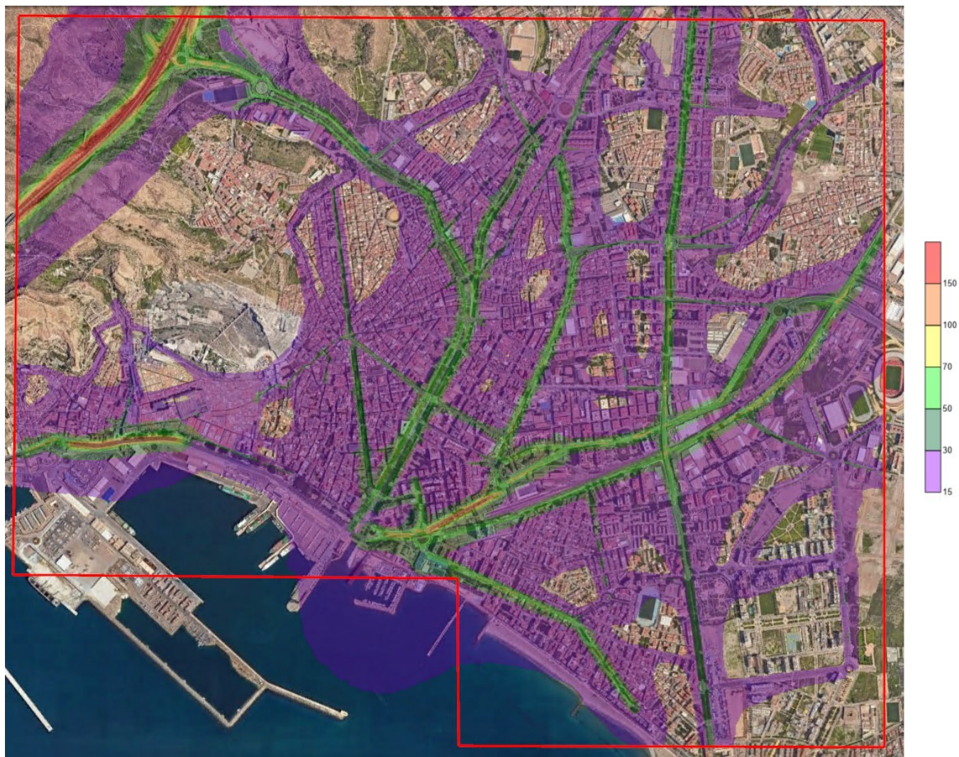
Figura AIV.12. Contribución del tráfico al percentil 99,79 de los niveles medios horarios de inmisión de NO 2 (µg/m 3 )
