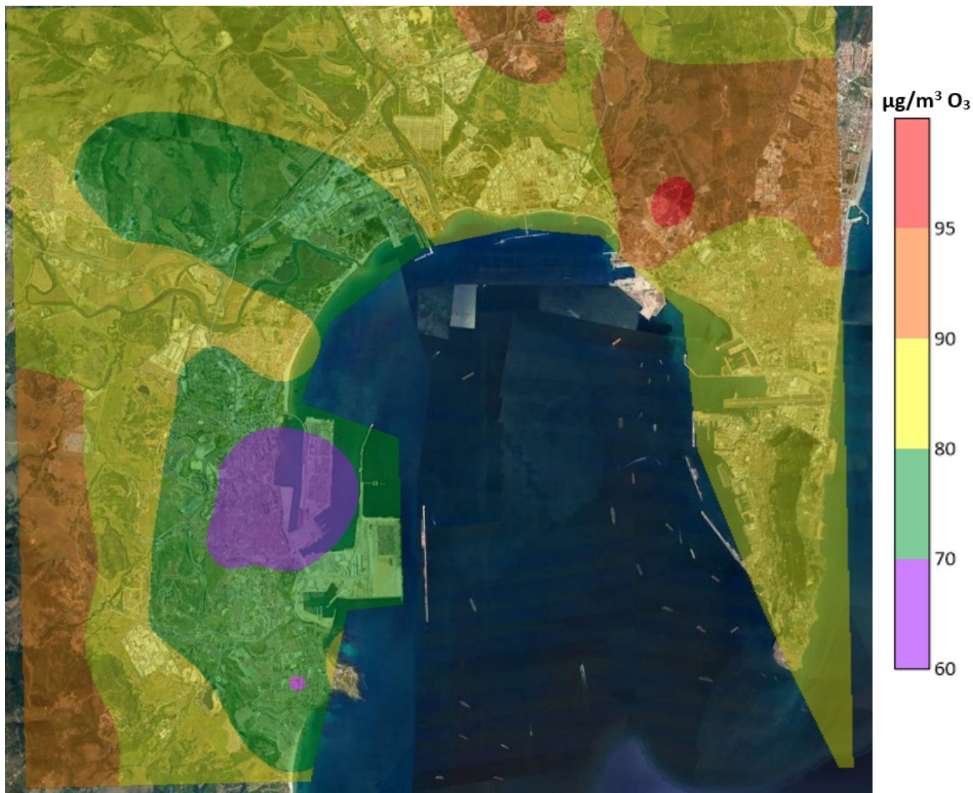
Figura 5.26. Resultados de la campaña de captadores difusivos de O 3 (µg/m 3 ) en Bahía de Algeciras
