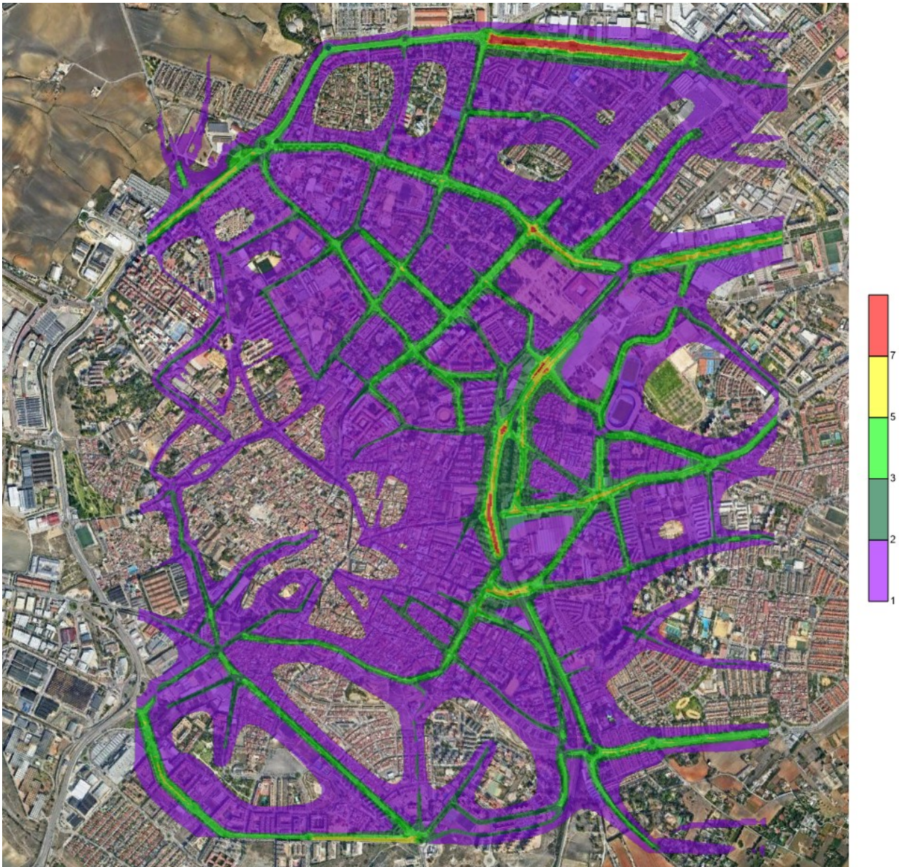
Figura AII.12. Contribución del tráfico a los niveles medios anuales de inmisión de \text{NO}_2 ( \mu\text{g}/\text{m}^3 )
