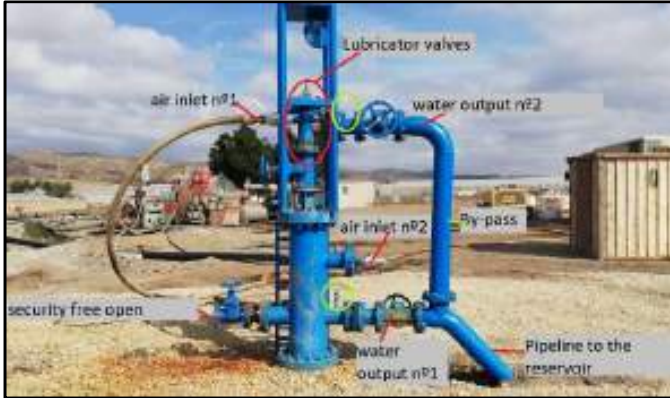
Fotografía 1: Cabezal de sondeo para testificaciones, propiedad de Cardial, con castillete y válvula lubricador para introducción de tren de sondas y trabajar con el sondeo completamente cerrado y presurizado.
