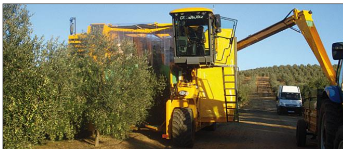
Figura 8.- Cosechadora integral.-
