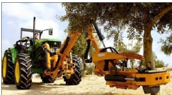
Figura 5.- Derribo con vibrador de tronco.-
