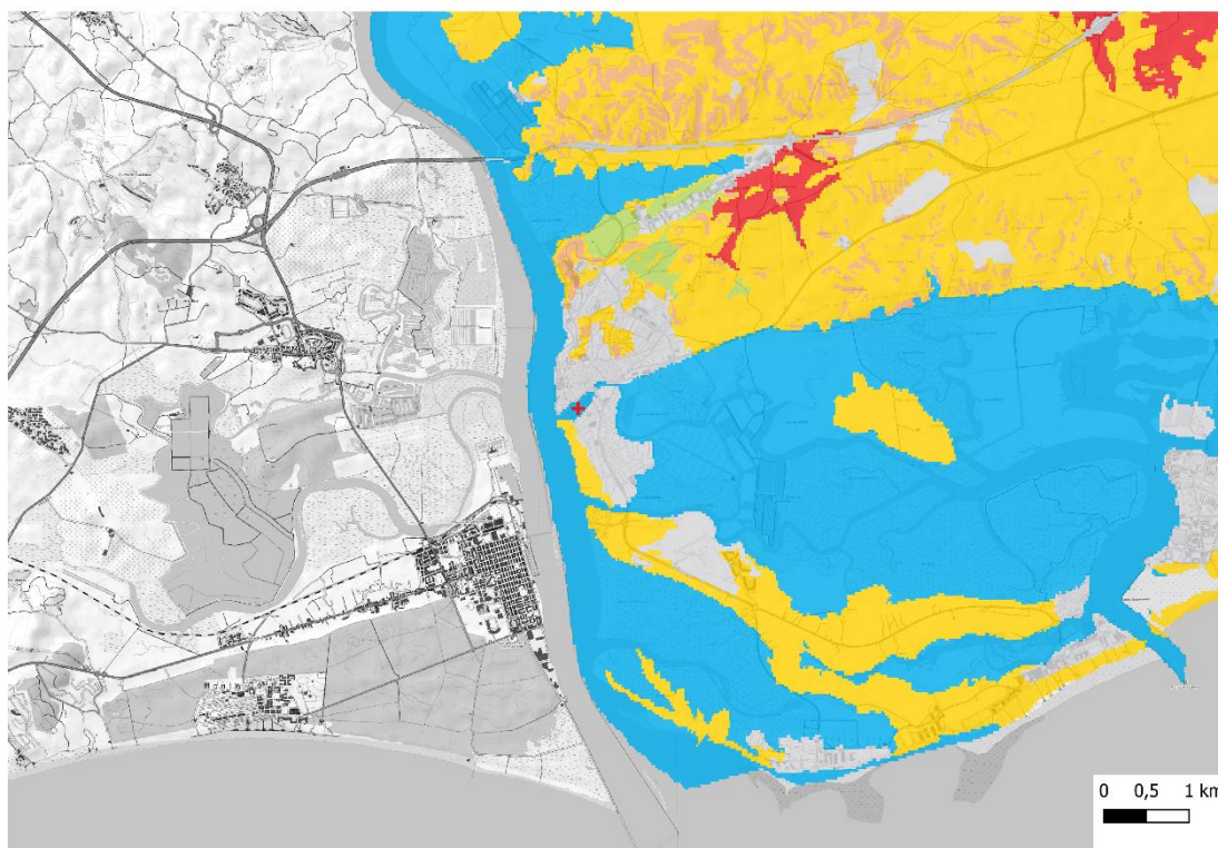
Figura 30. Riesgo de deslizamientos en el entorno de la zona objeto de estudio
