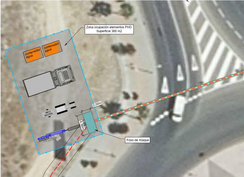
Imagen 2. Detalle foso de ataque de la Perforación Horizontal Dirigida (Tipo B)
